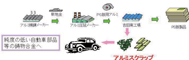
図4 従来の断裁屑のリサイクル（カスケードリサイクル）
